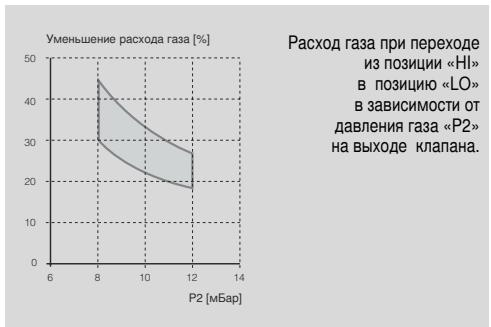
Расход газа при переходе из позиции «HI» в позицию «LO» в зависимости от давления газа «P2» на выходе клапана.
