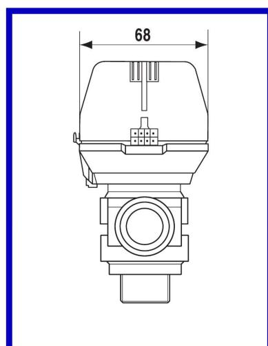
1) Пример использования в качестве трёхходового зонального вентиля
